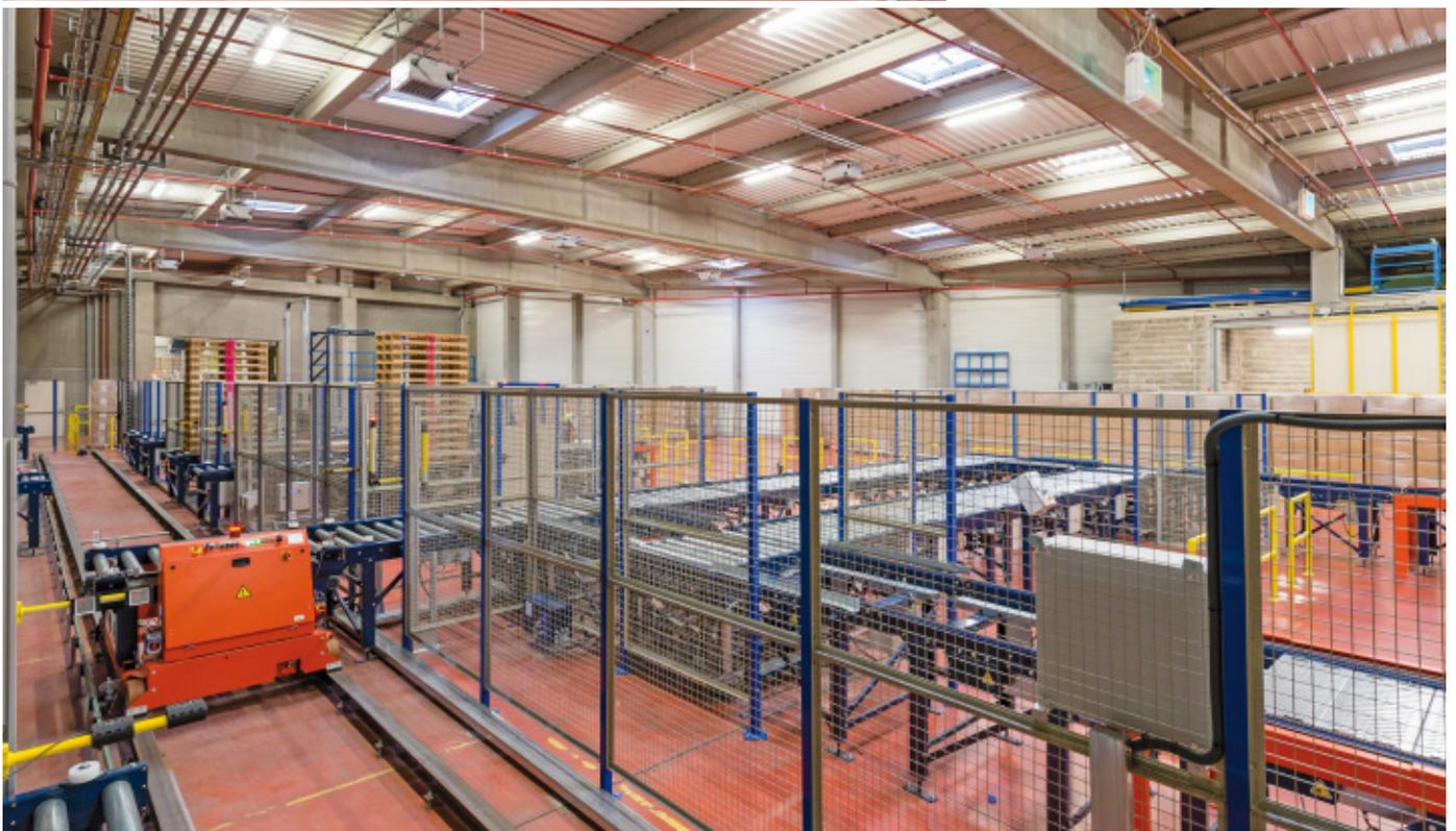
Le circuit de convoyeurs est également équipé d'un remonteur qui permet de lever les palettes pour les placer sur des palettes esclaves et d'un poste pour empiler et dé-empiler les palettes vides.
