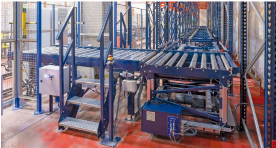
La marchandise qui ne passe pas le contrôle est acheminée vers le convoyeur de rejet, situé en parallèle, pour être reconditionnée.
