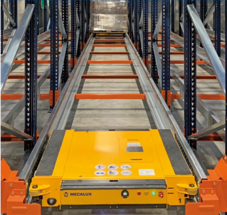
**Le producteur de sauces, Manna Foods, a transformé son entrepôt de Wijnegem (Belgique) en y installant le système Pallet Shuttle de Mecalux. Cette solution exploite l'espace disponible pour offrir une plus grande capacité de stockage : 1 120 palettes sur seulement 350 m<sup>2</sup>, grâce à une navette motorisée chargée de la manutention des marchandises accélérant ainsi les entrées et sorties des palettes.**
