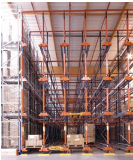
Navette Pallet Shuttle avec caméra intégrée, pilotée par tablette tactile
