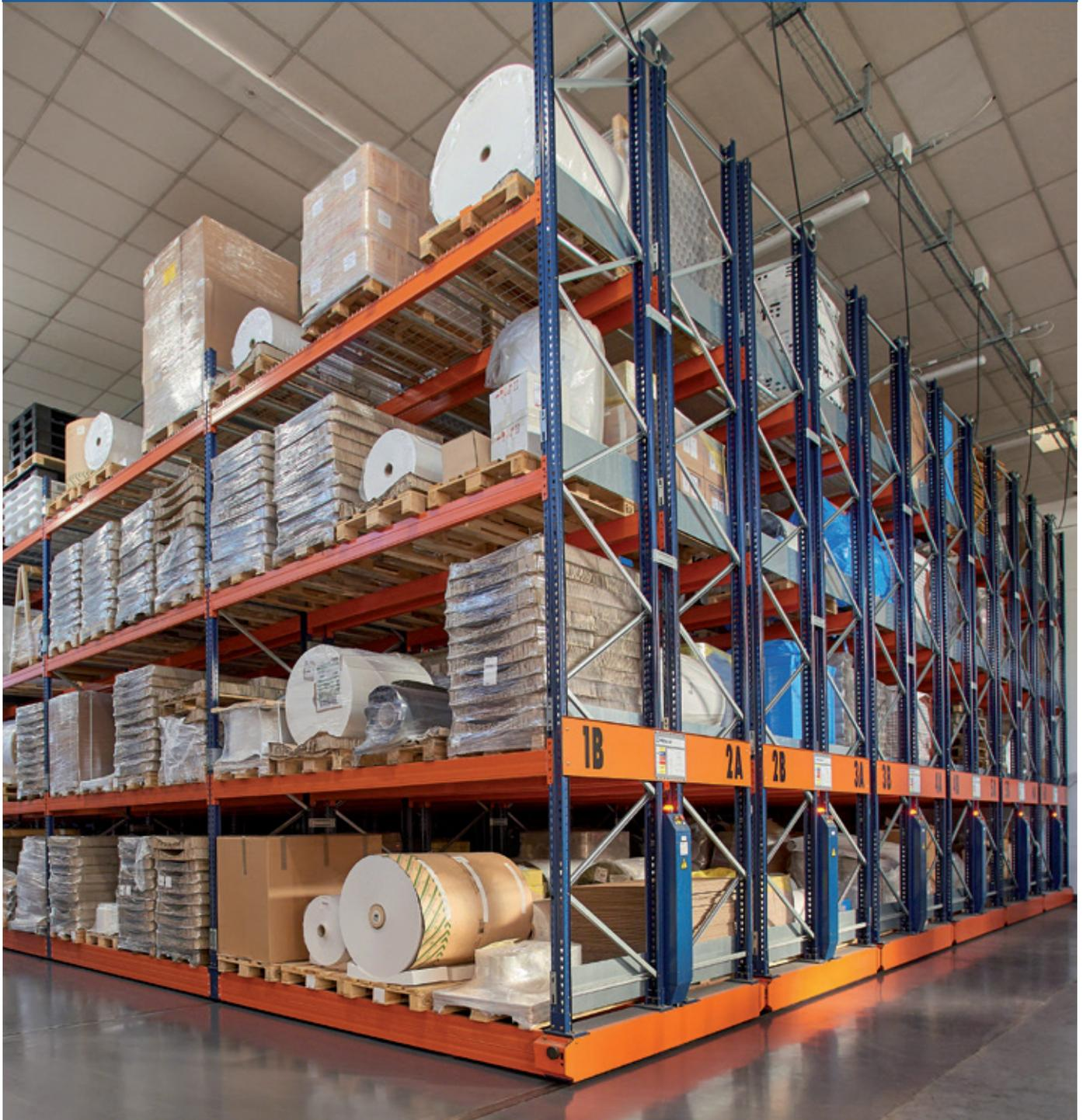
Besafilm a équipé son entrepôt de Cognola ai Colli (Italie) de rayonnages sur bases mobiles Movirack de Mecalux. Ce système par accumulation exploite tout l'espace disponible pour offrir une capacité de stockage de 2 032 palettes. De plus, il offre un accès direct aux marchandises lorsqu'une allée de travail est ouverte.
