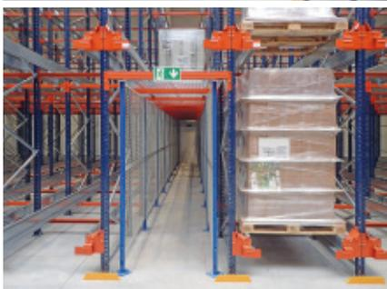
**Mecalux a équipé l'entrepôt du prestataire logistique Weddeling à Borken (Allemagne) de deux blocs de rayonnages avec le système Pallet Shuttle semi-automatique. Avec cette solution, permettant de stocker 4 876 palettes, l'entreprise a accéléré les entrées et sorties des marchandises.**
