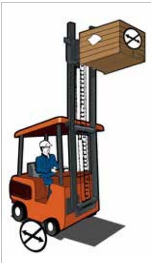
Figure 1. Ne pas circuler avec des charges en position haute.
