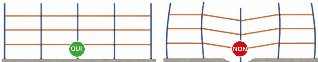
Un affaissement ou un déplacement de la dalle peut entraîner la modification de la verticalité des échelles. Les éventuelles irrégularités du sol peuvent être corrigées à l'aide de plaques de nivellement qui doivent être correctement mises en place sous les pieds. Un mauvais positionnement de ces plaques peut entraîner une augmentation de la pression exercée sur la dalle, voire provoquer le déséquilibre de l'échelle.
