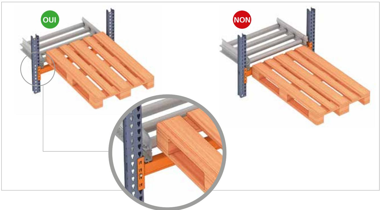
Les manœuvres de descente et de levage de la charge doivent être réalisées avec les fourches centrées et en position horizontale. Ces opérations doivent être effectuées à vitesse minimale.
