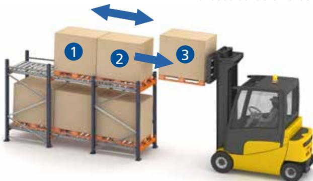
**Étape 3 :** Pour retirer les palettes, il suffit de procéder dans le sens inverse de sorte que lorsque la première palette est retirée, la seconde se déplace d'une position en direction de l'allée.
